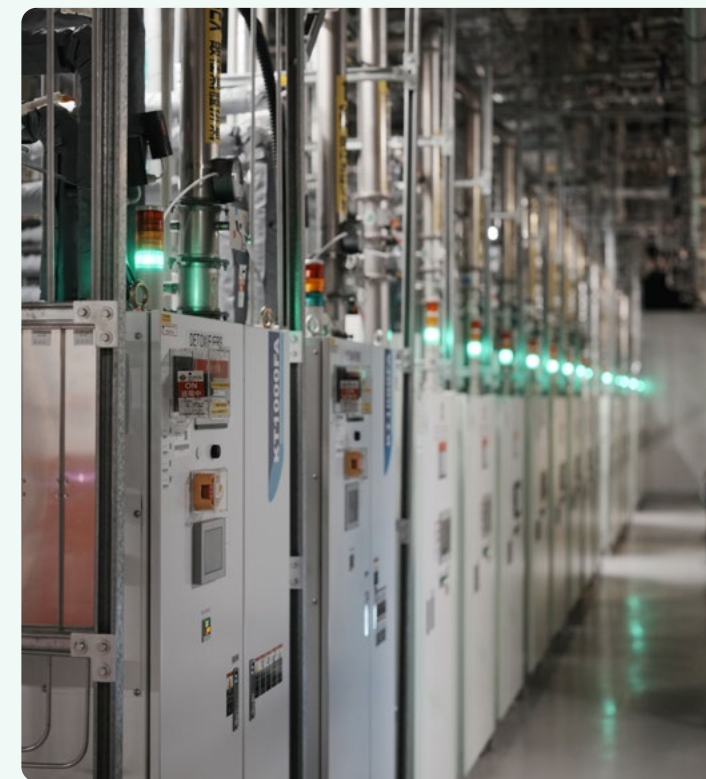
台積公司改良電熱式現址式處理設備備機待機模式
